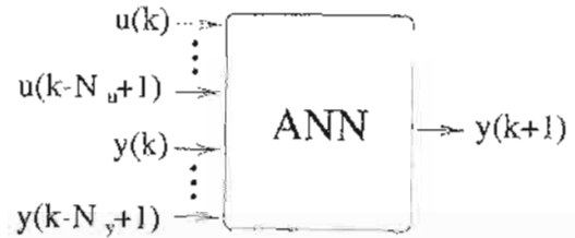
Figura 1: Esquema de la identificación entrada/salida con una red neuronal.
