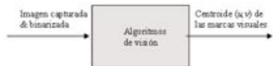
Figura 6. Diagrama de proceso de los algoritmos de visión por computadora.
