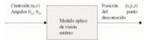
Figura 10. Proceso realizado por el modelo óptico de estereovisión.
