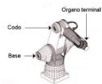
Figura 1. Partes del robot A465.
