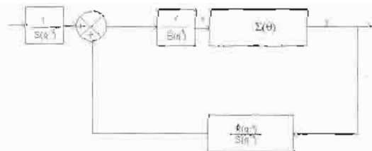
Figura 3 Esquema de Control Adaptable para Sistemas de Fase Mínima
