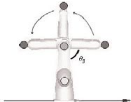
Figura 18. Experimento variando el ángulo q_3 del robot A465
