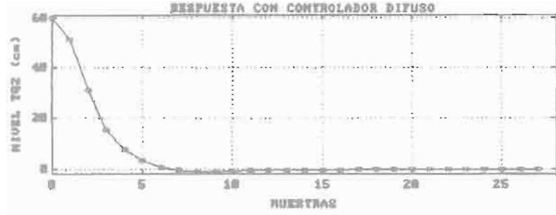
Fig. 12.a. Controlador Difuso (Punto de ajuste 0%, nivel actual 60 cm)
