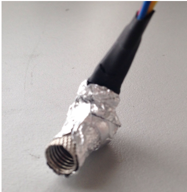
Figura 8: Cilindro de aluminio para limitar el campo de visión
