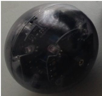
Figura 3: Pelota infrarroja para RoboCupJunior Soccer marca HITECHNIC
