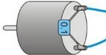
Figura 6. Forma de conexión de capacitor cerámico 104 en los motorreductores.
