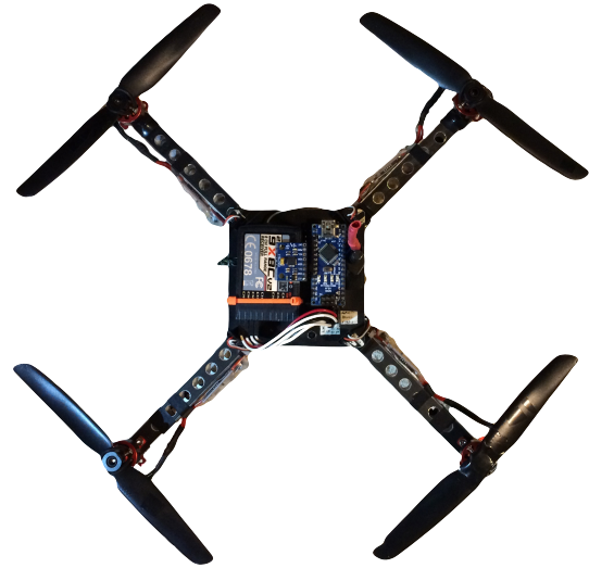
Figura 1: Tercera iteración de construcción del cuadricóptero
