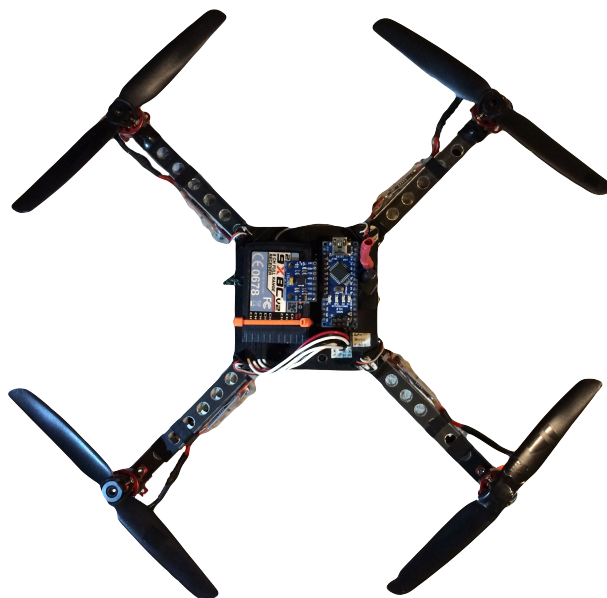
Figura 1: Tercera iteración de construcción del cuadricóptero
