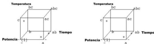
Figura 4. Dominio experimental, en una vista geométrica para tres factores continuos en variables codificados (izquierda) y los factores continuos y uno discontinuo en variables reales (derecha). Los experimentos de los vértices son los utilizados en el diseño factorial completo  $2^3$
