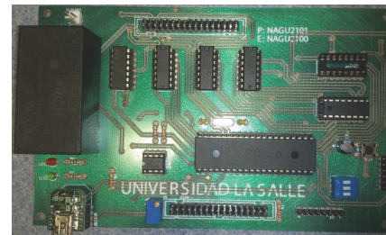
Figura 4. Resultado de la manufactura de la tarjeta principal
