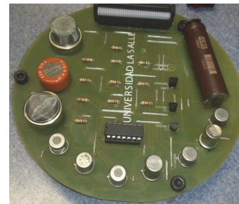
Figura 5. Resultado de la manufactura de la matriz de sensores
