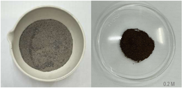
Figura 1. Escoria de alto horno antes y después del tratamiento
