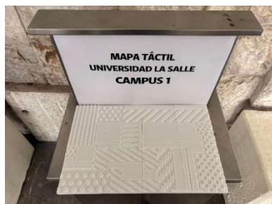
Figura 1. Mapa táctil impreso en 3D a partir del modelo del campus. Fuente: Elaboración propia.
