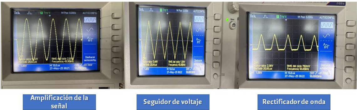
Figura 2. Comprobación de las etapas de amplificación, seguidor de voltaje y rectificador de la señal en el osciloscopio.
