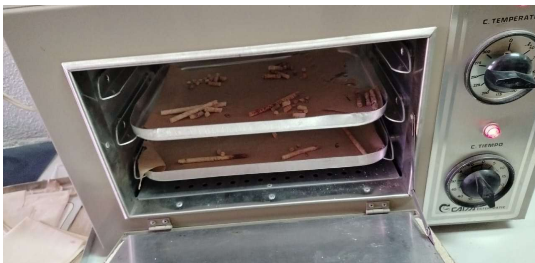
Figura 5. Proceso del secado de Muestras, ULSA Morelia (Laborat.). Imagen de autoría propia
