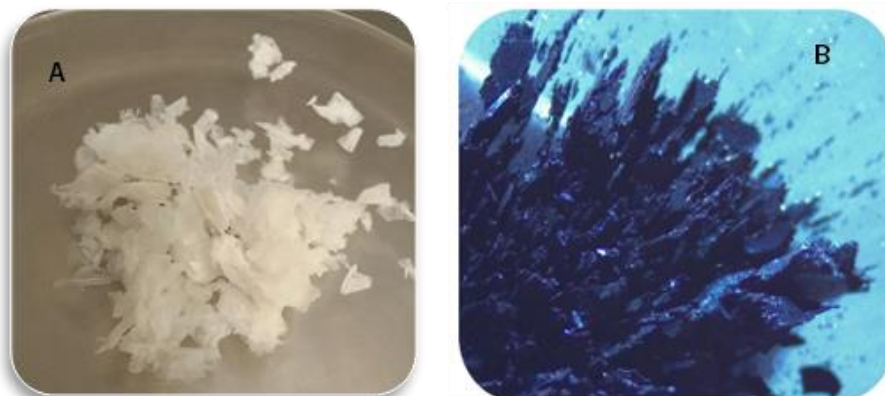
Figura 1. A. Quitosano obtenido a partir de residuos de camarón. B. Catalizador ferromagnético sintetizado.
