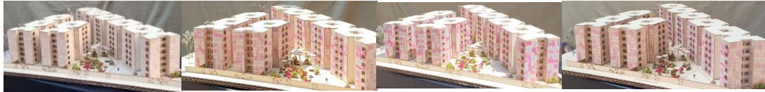
Figura 2. Maqueta experimental escala 1:200 bajo incidencia solar a lo largo del día 6:00 am, 11 am, 3 pm y 5 pm respectivamente de izquierda a derecha. Fuente elaboración propia.
