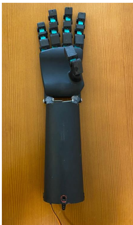
Figura 3. Prototipo final de prótesis de miembro superior. Fuente. Elaboración propia.
