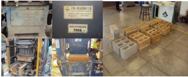
Figura 1. Lado izquierdo Vista de los equipos de vibro compactación para moldeo de bloques huecos y sólidos. Lado derecho Vista de los bloques huecos y sólidos del BRE en laboratorio para pruebas mecánicas. Fuente: Archivo de los autores.
