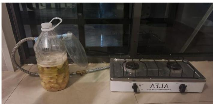
Figura 2. Prototipo de la estufa ecológica. Elaboración propia.
