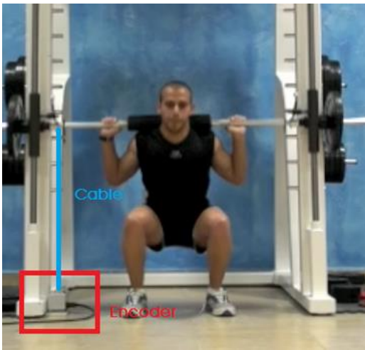
Figura 3. Utilización de un encoder tradicional en un levantamiento de fuerza.
