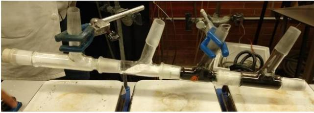
Figura 1.1. Prototipo del tren de tratamiento del efluente.
