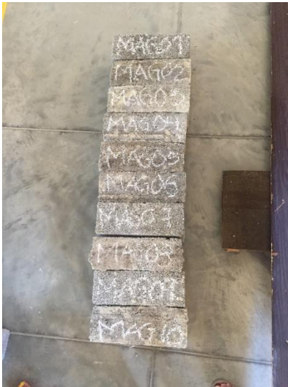
Fig. 5. Lote de probetas MaG-I para prueba de compresión simple.
