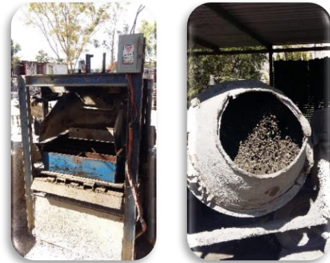
Fig. 2 Revolvedora y vibrocompactadora para la manufactura de tabicones.
