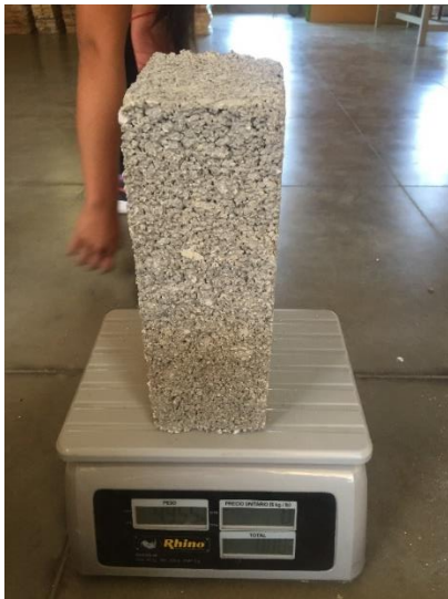
Fig. 6. Medición de la masa de probetas MaG-I.
