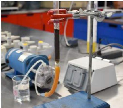
Figura 3. Sistema de desplazamiento de hidrocarburo por inundación
