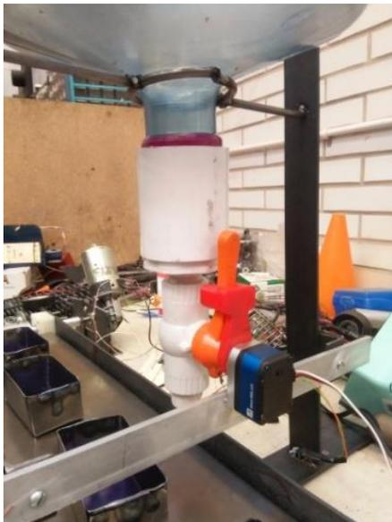
Figura 5. Ensamble del motor a la válvula.
