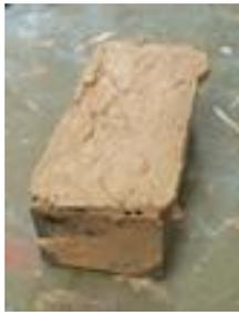
Figura 4. Ladrillo hecho con molde de lámina.
