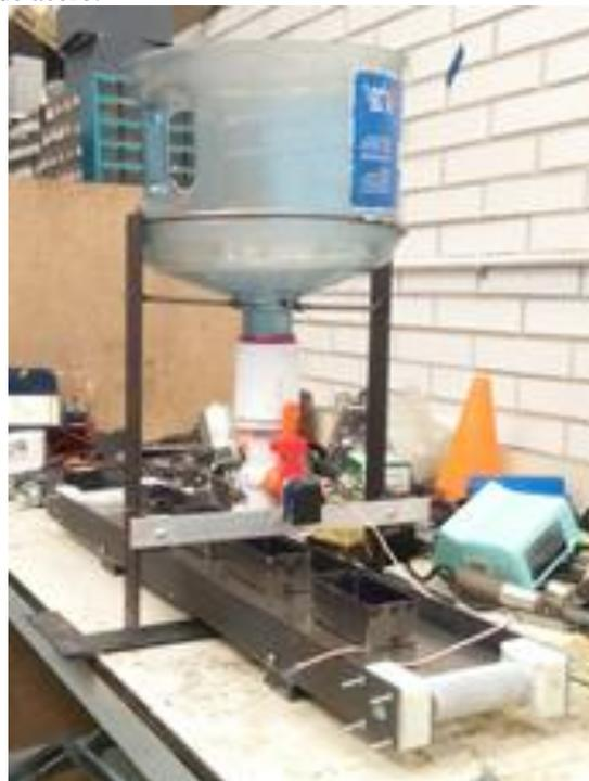
Figura 3. Tolva y banda transportadora.
