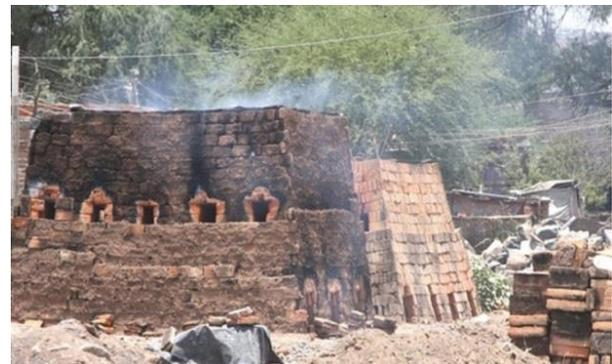
Figura 1. Producción de ladrillos artesanales.
