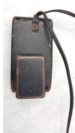
Figura 8. Reóstato de pedal empleado para regular la velocidad a la que gira el eje del motor y de la turbina
