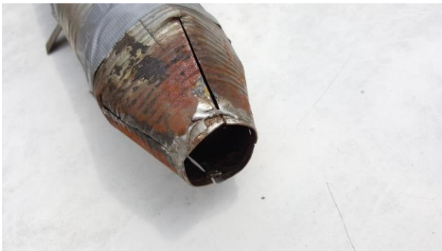
Figura 6. Salida de Aire tipo Venturi de nuestra turbina hecha de latas cortadas y soldadas con estaño
