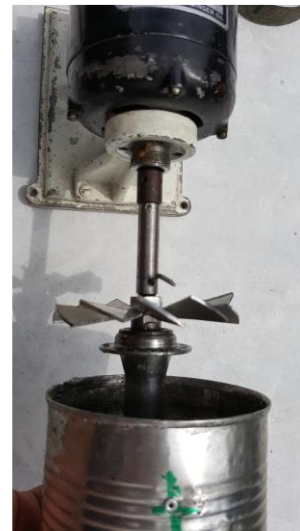
Figura 9. Unión del eje principal de la turbina con el motor antes de ser cubierto por el fuselaje
