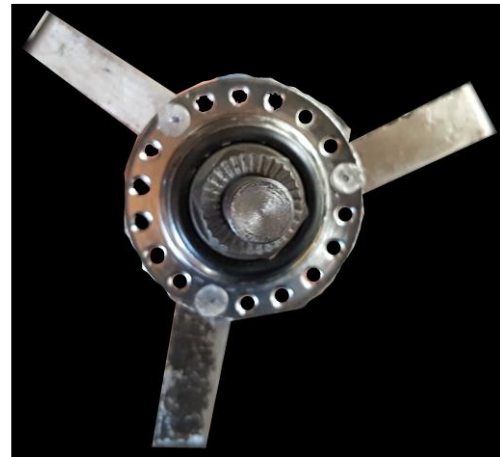
Figura 2. Soporte Anillado con tres patas que se atornillan o se arremachan al fuselaje
