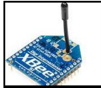
Figura 4. Módulo de radiofrecuencia Xbee
