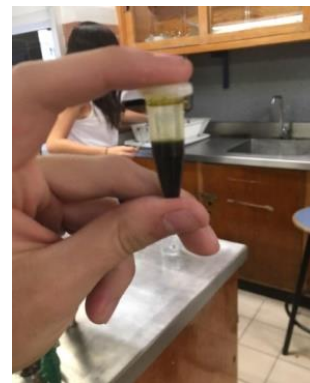
Figura 4 Extracto de alga sargazo después de remover el solvente
