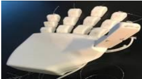
Figura 21. Ensamble de prótesis de mano Como V.
